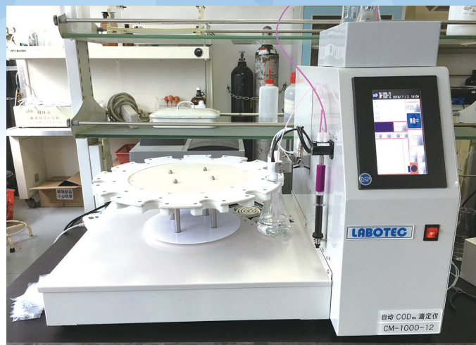
広東省深圳市環境モニタリングセンターに納品した自動 CODMn 滴定装置
