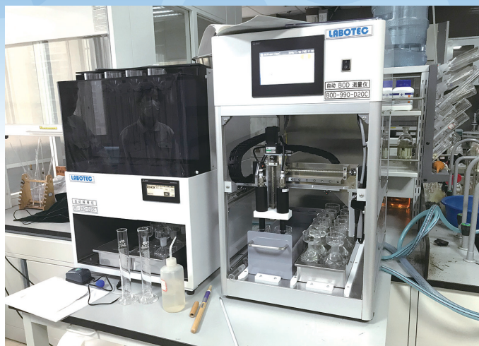
四川省環境モニタリングセンターに納品した自動 BOD システム 250ml
