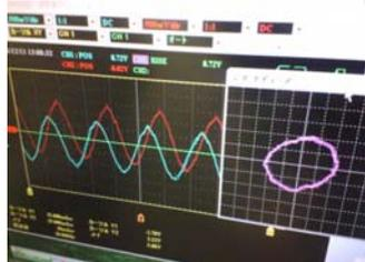
図2 振れの測定結果
