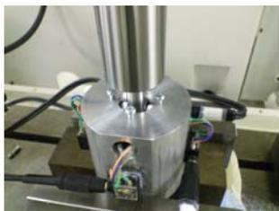
図1 主軸回転振れ測定
