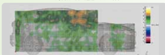
その音が通過するときの車体パネル振動分布
