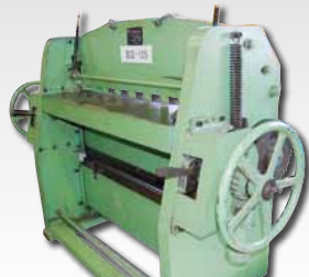
開発から半世紀経った今も現役 で活躍している手動切断折曲機。
