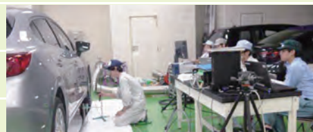
地場サプライヤー参加による振動・騒音解析実験
