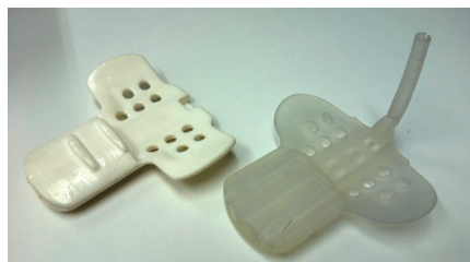
医療用マウスピース製品試作 左:3Dプリンターによる試作出力(積層0.1) 右:試作金型による量産製品試作
