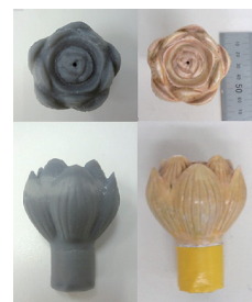
製品原型を3Dスキャン後プリント出力 左:光造型による3Dプリント(積層0.05) 右:原型
