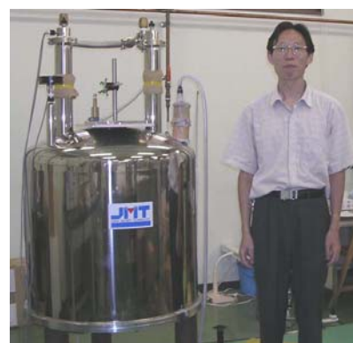
図1 高磁気力用超伝導磁石
