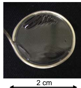
図2 磁場による微小重力場を利用して作成したPVA薄膜
