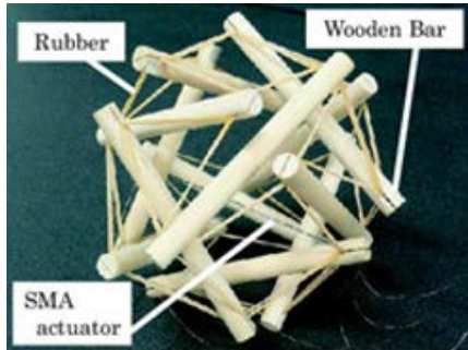
②テンセグリティ構造体を利用した変形ロボット
