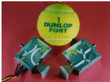
〔図3〕 簡便高性能な超高周波トランシーバ
